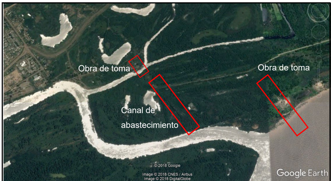
Figura N°4.2. Ubicación de la Obra de Toma. (Fuente: Google Earth del 17-11-17)
