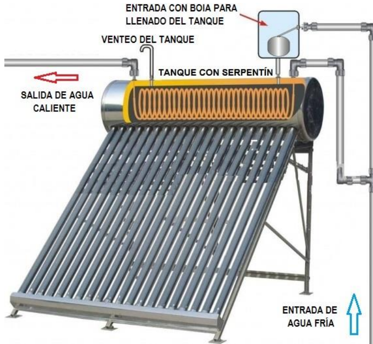
IMAGEN N° 19: Esquema gráfico del funcionamiento de un termotanque solar por termosifón
