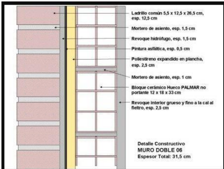
IMAGEN N° 17: Detalle constructivo de muro con aislamiento
