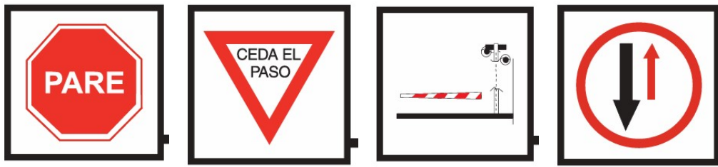
Figura 44. Señalización vertical de Prioridad de izquierda a derecha: Pare (R27), ceda el paso (R28), barreras ferroviarias (R30), preferencia de avance (R29) Fuente Anexo "L" ley de tránsito 24.449
