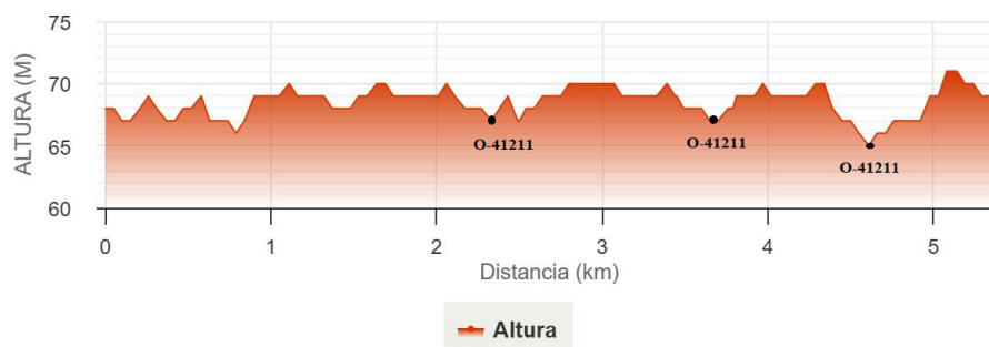
Figura 29. Perfil longitudinal de la traza, Portal IGN + MDE 5m. Fuente: Elaboración propia.
