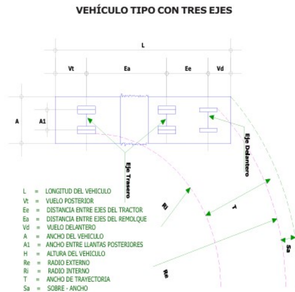
Figura10. Características Geométricas del Vehículo de diseño – Fuente Manual de diseño Geométrico M.TyC
