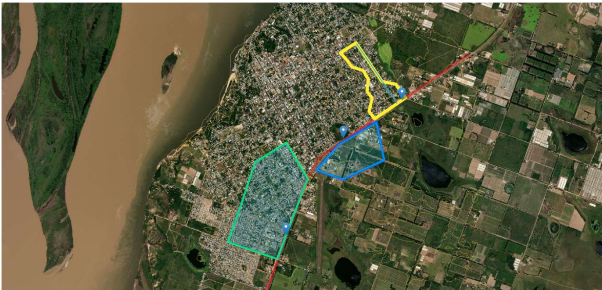
Imagen 11. Sistema de escurrimiento superficial, con sus áreas de aportes. Fuente: Geoportal Sistema IGN con curvas de nivel, mde 5m. e identificación de Laguna.
