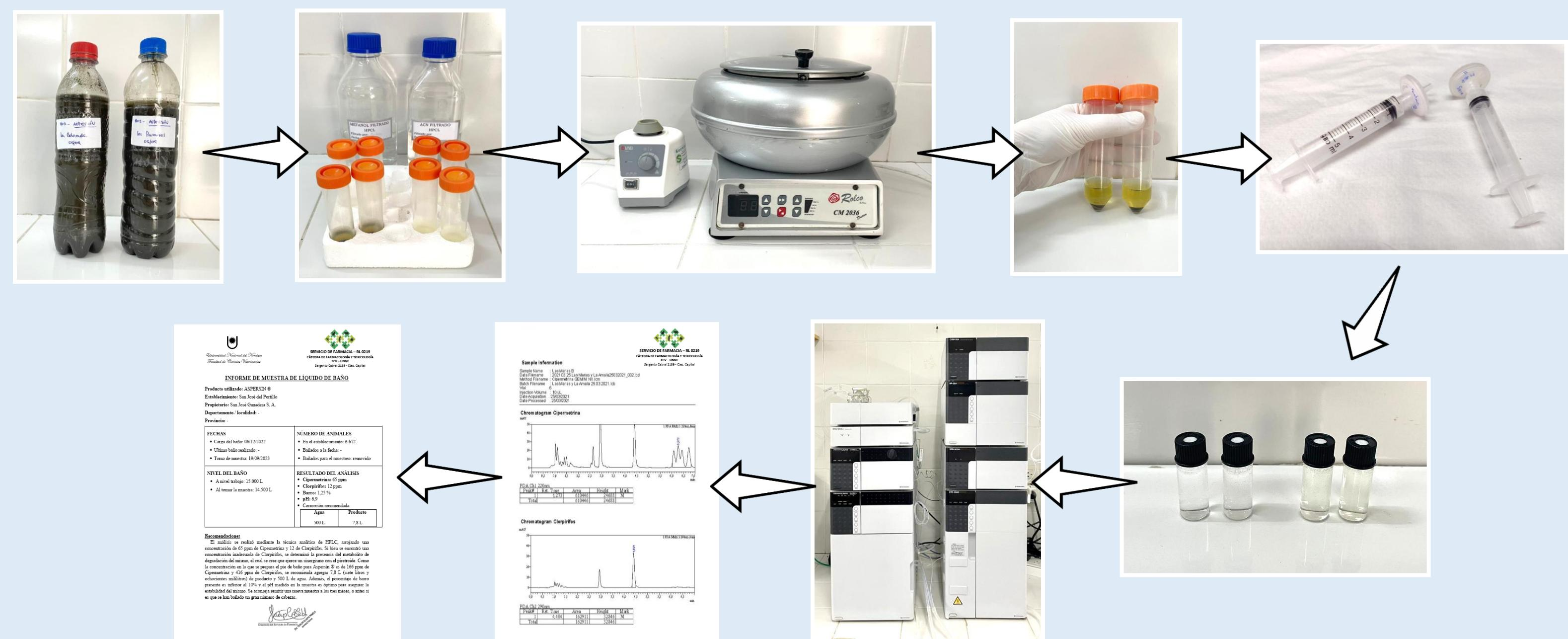
La determinación de la concentración de los analitos de interés se realizó mediante un equipo de Cromatografía Líquida de Ultra Alta Presión (UHPLC Shimadzu Prominence Serie 20A), con detector de diodos (PDA) y columna de fase reversa (Gemini NX), previa extracción en fase líquida con un vórtex (DLAB MX-S) y separación de los sedimentos con centrífuga (ROLCO CM 2036).
