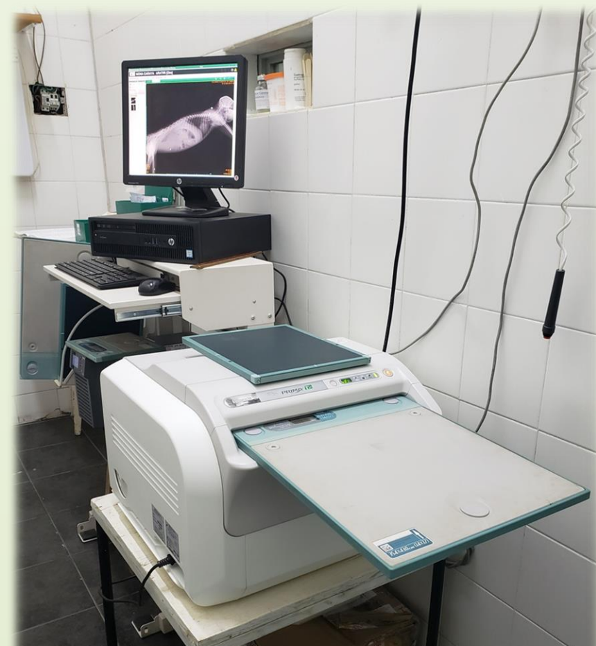
Figura N°2: sistema digitalizador de pie de marca FUJIFIL y Chasis con pantallas de fósforo.
