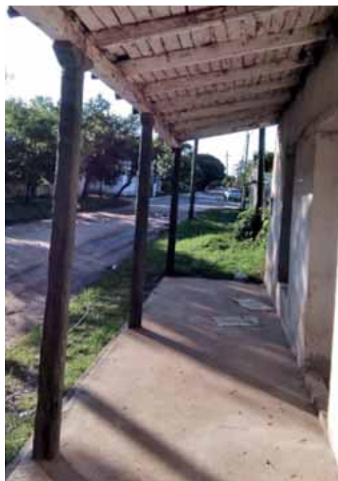
Figura 8. Vivienda estereña. Este tipo de construcción que se está perdiendo nos hace ver cómo sería la construcción en la que habitaron los primeros habitantes de estas regiones. Realizadas tanto en paredes como cubierta con fibra de "espartillo"
