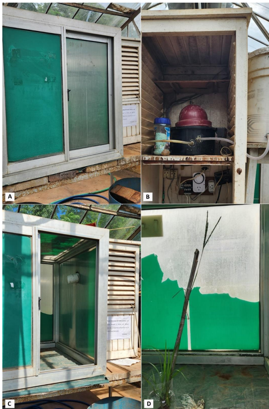
Figura 7: Cámara de niebla artificial. A) Detalle de cámara cerrada. B) Casilla adosada a la cámara conteniendo el humidificador, generador de niebla artificial, y tablero de comando. C) Detalle de cámara abierta, unida a la casilla que contiene el humidificador, se observa tubo de ingreso de niebla artificial. D) Porción de planta en recipiente con agua y soporte para mantener erecta la inflorescencia preparada para ser polinizada dentro de la cámara.
