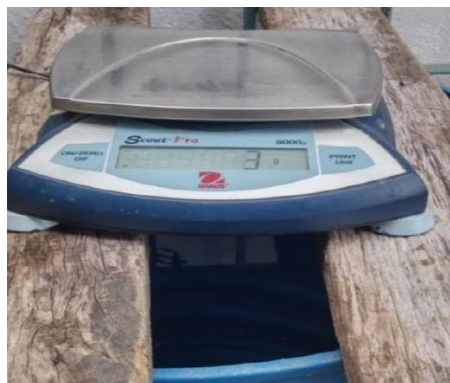
Figura 9. Balanza utilizada en el método de gravedad específica para determinar materia seca (%) y almidón (%).
