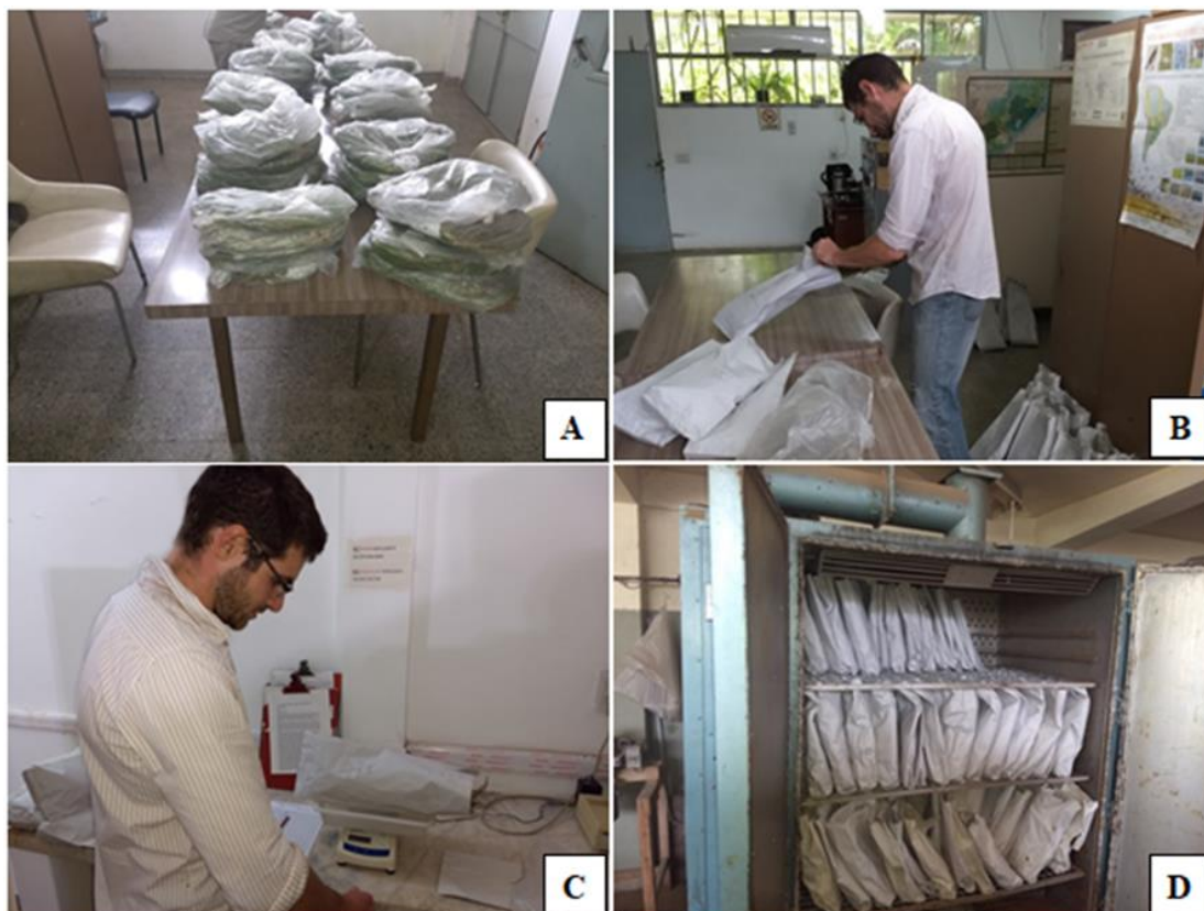
Imagen 3: A y B) acondicionamiento de las muestras, agrupadas según lote de procedencia y pasadas a bolsas de papel, C) pesaje de las muestras mediante balanzas digitales, D) secado de las muestras en estufa de aire forzado (65°) por 48 horas.
