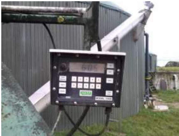
Foto 48: Balanza incorporada al contenedor
