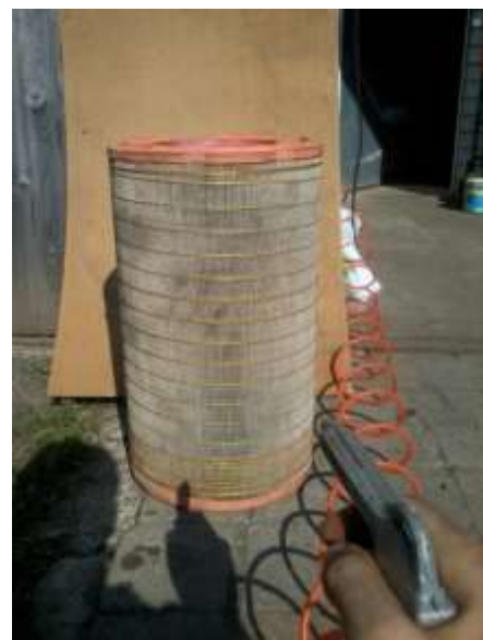
Foto 51: Limpieza de filtros de los motores
