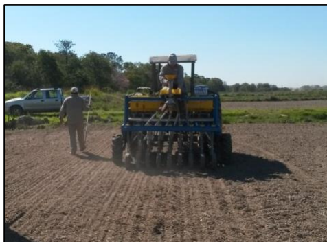
Figura 2. Siembra en franjas de cuatro variedades de arroz con sembradora experimental Semina de 9 surcos.
