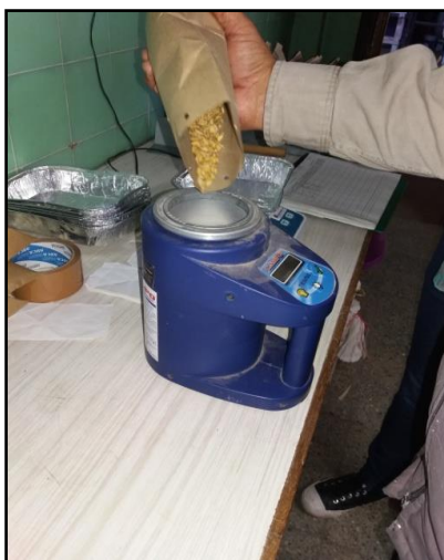
Figura 10. Humedímetro Tesma Campo utilizado para medir humedad de los granos en laboratorio.
