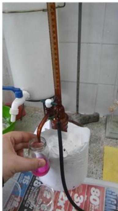
Figura 11: Detalle de la titulación.
