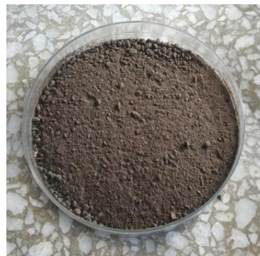
Figura N° 14: Placa con suelo seco y nivelado.
