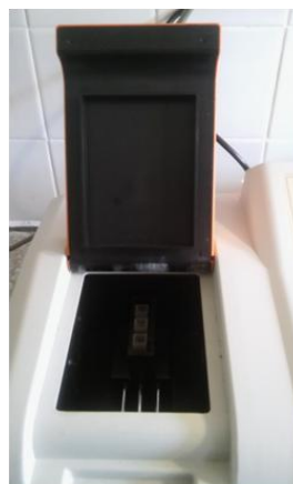
Figura 24: Celdas en las cavidades del interior del espectrofotómetro.
