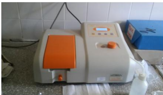
Figura 21: Espectrofotómetro BIOTRAZA 722 perteneciente a la Cátedra de Microbiología.
