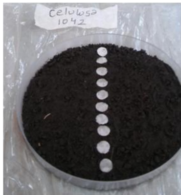
Figura 16: Disposición de la primera fila de discos sobre el suelo.
