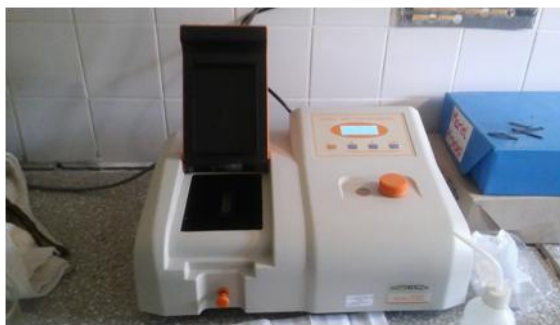
Figura 22: Detalle del interior del espectrofotómetro, donde se encuentran las cavidades para introducir las celdas.
