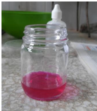
Figura 10: Recipiente con alícuota, cloruro de bario y fenolftaleína.
