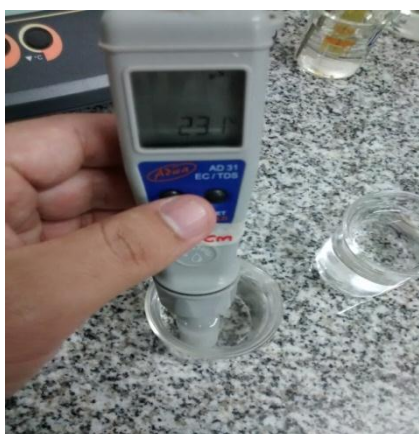
Figura 1: Lectura de la conductividad eléctrica en muestra de agua con el equipo para dichas mediciones.
