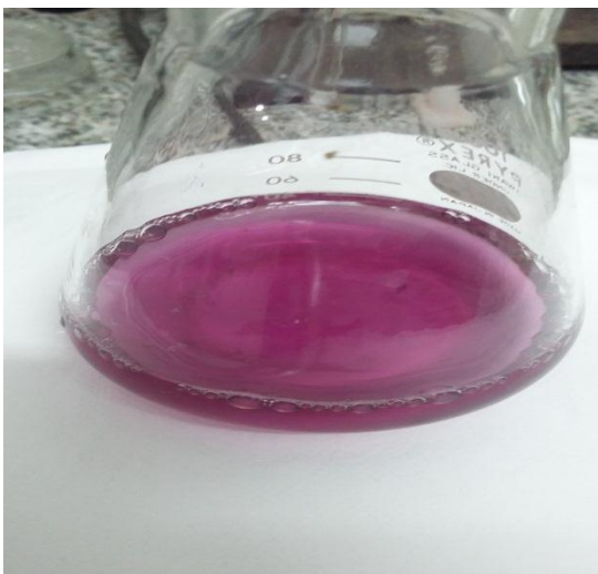
Figura 9: Colores que presentan los indicadores al momento de iniciar la titulación se observa el color rojo vinoso para luego virar a azul momento en el cual se corta la titulación, ambos indicadores presentan los mismos colores de viraje.
