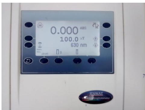
Figura 6: Espectrofotómetro llevado a cero de absorbancia con el blanco.
