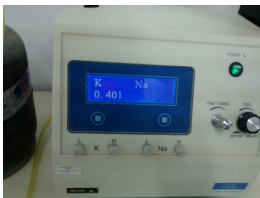
Figura 11: Fotómetro de llama para lectura de sodio y potasio al mismo tiempo.
