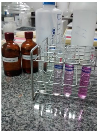
Figura 7: Desarrollo del color en la reacción de cuantificación de nitritos en agua.
