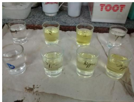
Figura 8: Desarrollo de color amarillo de la reacción colorimétrica indicando la presencia de nitratos.
