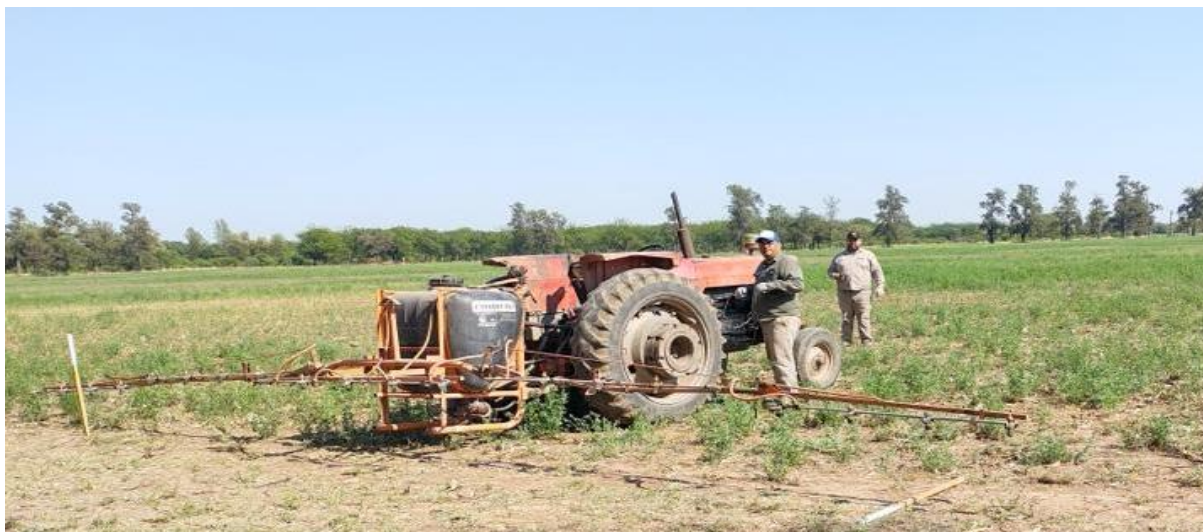
Figura 10: Pulverizadora de 3 puntos Jacto Condorito.
