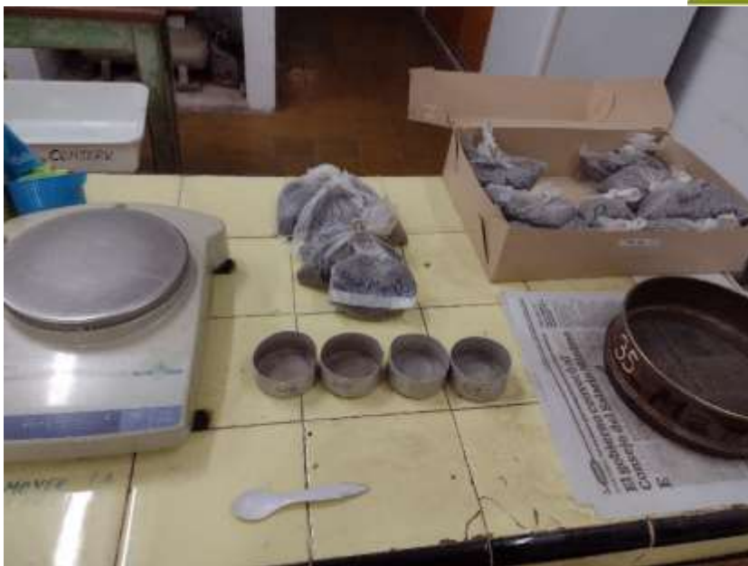
Figura 2. Proceso de tamizado y pesado de las muestras.
