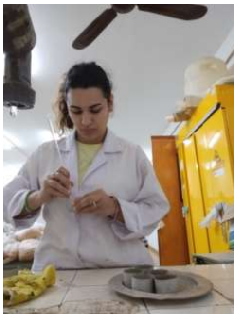
Figura 5. Proceso de destrucción de agregados remanentes con varilla de vidrio.
