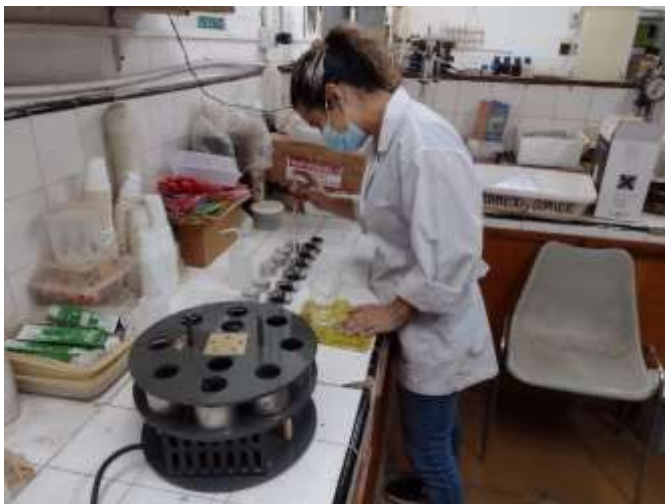
Figura 3. Proceso de humectación de las muestras, junto al equipo para la medición de la estabilidad de los agregados en húmedo.
