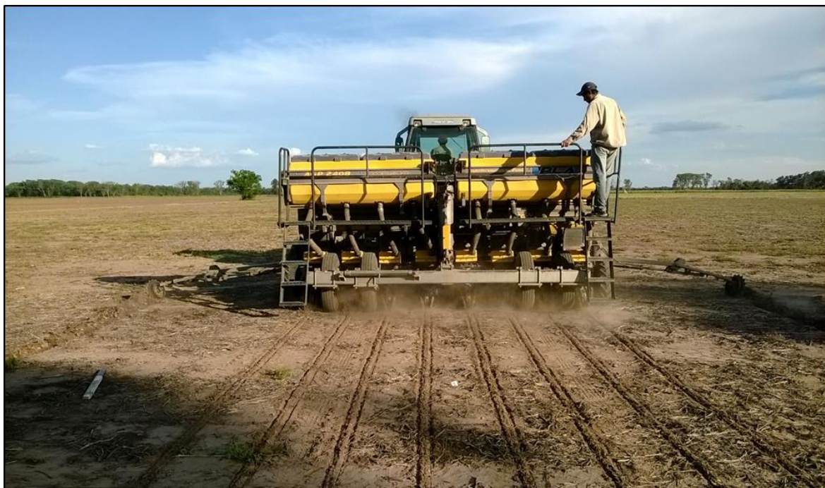
Imagen 5: Siembra mecánica: Sembradora PLA AGP 2408, ocho (8) surcos, separados a 0,525 m.
