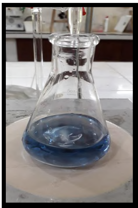
Fig. 12: Titulación. Color final en la determinación de calcio.
