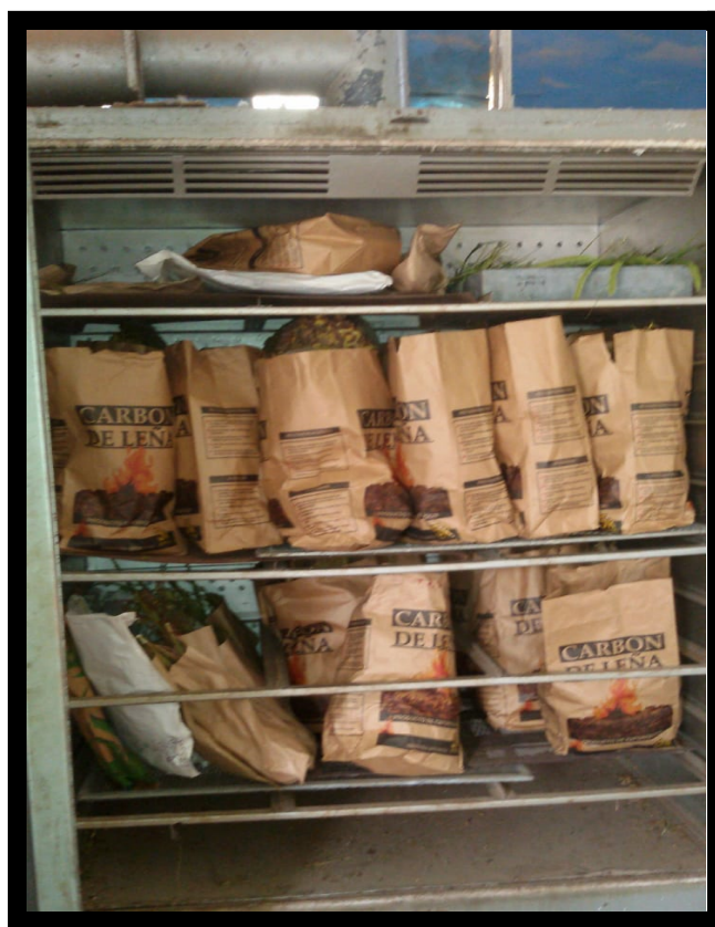
Fig. 30: plantas trozadas y colocadas en bolsas de papel en una estufa a una temperatura de 60°C.
