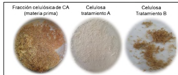
Figura 1. Imagen de la materia prima inicial (fracción celulósica de CA) y de los sólidos obtenidos pos tratamientos A y B.
