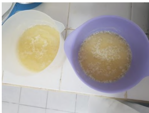
Figura N° 5: Cloruro de Calcio a la izquierda, Cloruro de Magnesio a la derecha, transcurridos 30 minutos.
