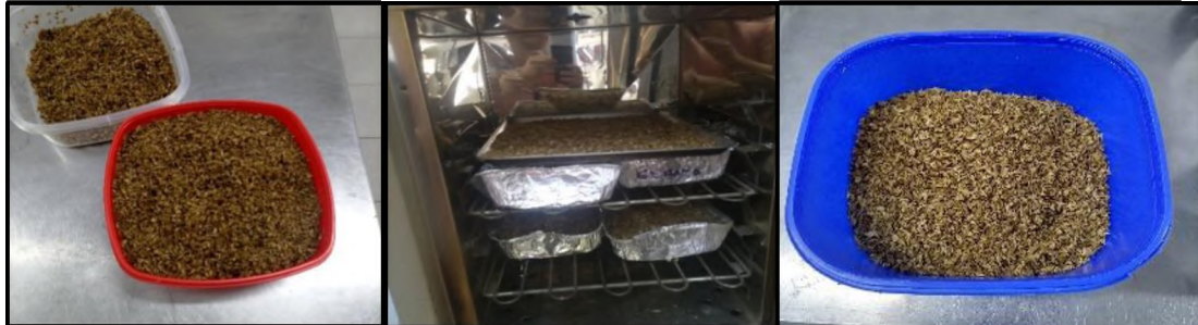
Figura 4: Bagazo húmedo (izq.), Bagazo en estufa de secado (cent.), Bagazo seco (der.)
