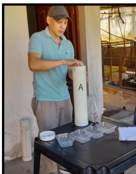
Figura 7: Descarte de los primeros 5 cm de cada extremo para la toma de muestra.
