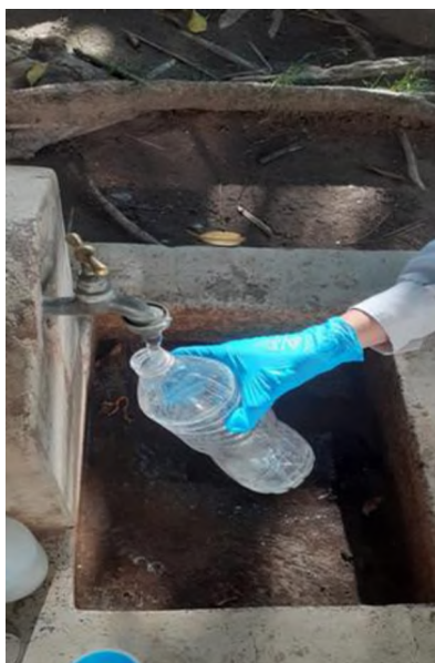
Figura N°3: extracción de muestra utilizando un grifo o canilla.
