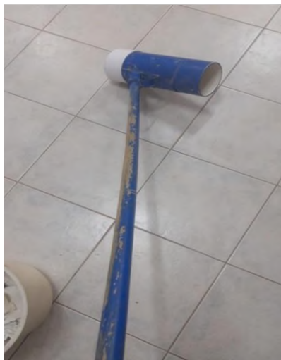
Figura N° 6: jabalina utilizada para el muestreo de aguas en movimiento.
