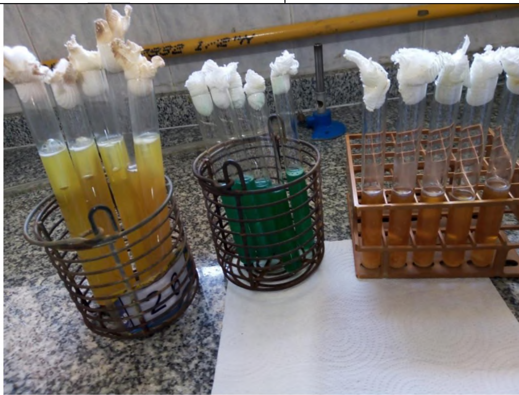
Figura N° 18: tubos positivos presuntivos a coliformes (a la izquierda), tubos confirmatorios positivos a coliformes totales (en el centro) y tubos confirmatorios positivos a coliformes fecales (a la derecha).
