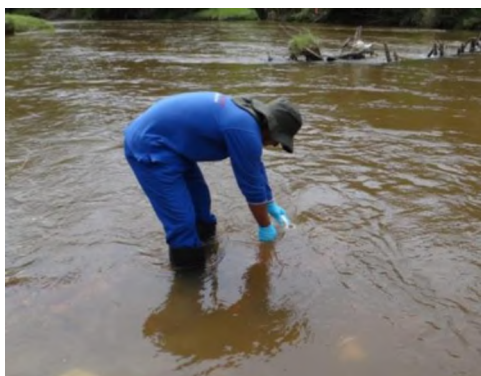
Figura N° 5: extracción de muestra de agua en movimiento.
