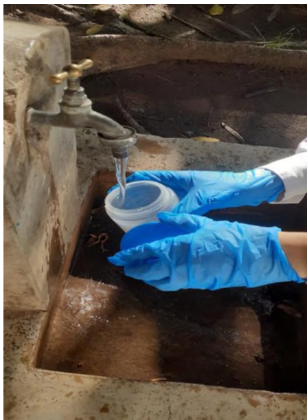
Figura N° 10: extracción de muestra para análisis bacteriológico.
