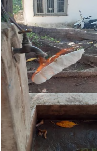
Figura N° 9: flameado de grifo previo a la toma de la muestra.
