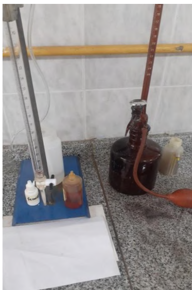
Figura N°15: a la izquierda, equipo de medición de alcalinidad y a la derecha, equipo de medición de cloruro.
