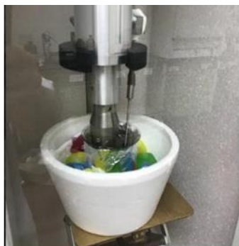
Figura 1: Sonda de ultrasonido de alta intensidad y vaso recipientado cubierto con hielo.
