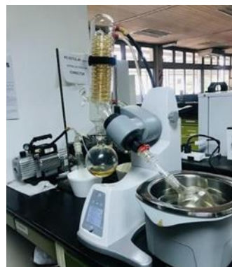
Figura 2: proceso de evaporación por destilación utilizando un rotavapor.
