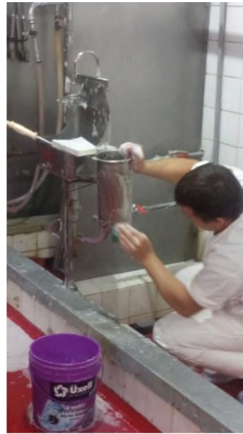
Figura 11: Limpieza de sanitadores
