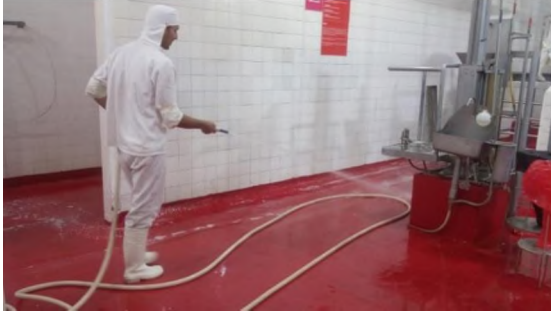
Figura 10: Lavado de pisos con agua a presión
