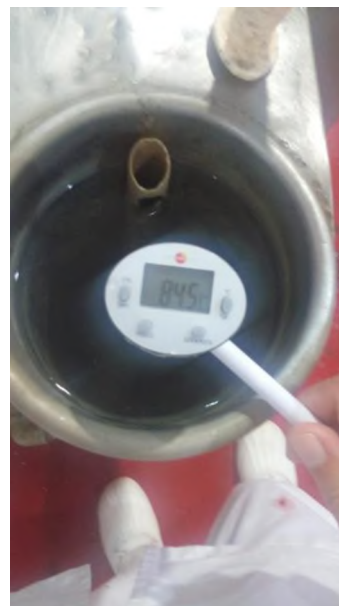
Figura 13: Temperatura de funcionamiento de los sanitadores
