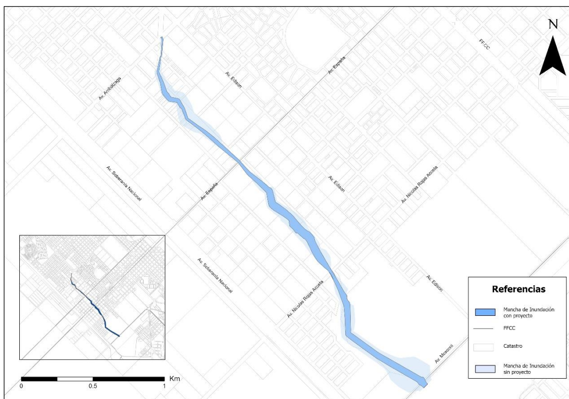
Figura N°6.7. Comparación de manchas de inundación. TR= 10 años. (Fuente: Elaboración propia).
