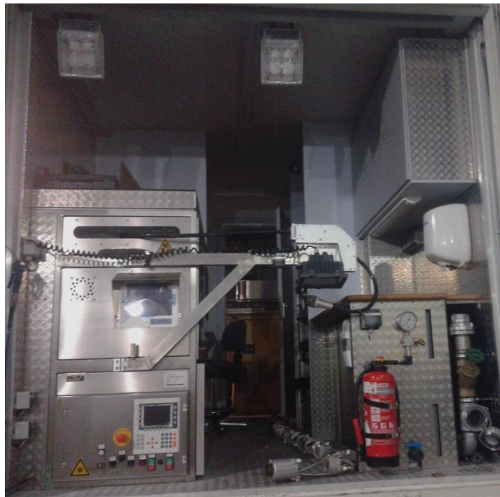
Camión con equipamiento para manga UV / Panel de control.
