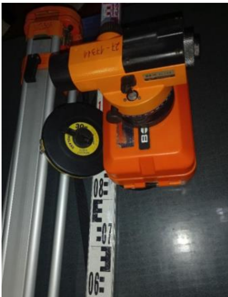
Imagen 23. Nivel óptico y mira topográfica mediante los cuales se llevó a cabo la nivelación en campo (Fuente: Fotografía propia, 2023).
