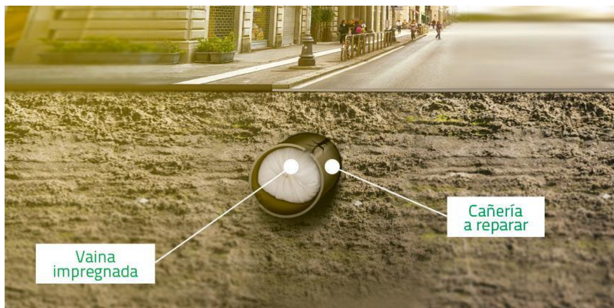
Figura 12. Sistema de Manga (Fuente: Forever Pipe, 2023).
