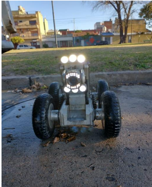
Imagen 13. Robot tele-cámara para inspección de cañerías (Fuente: Forever Pipe).
