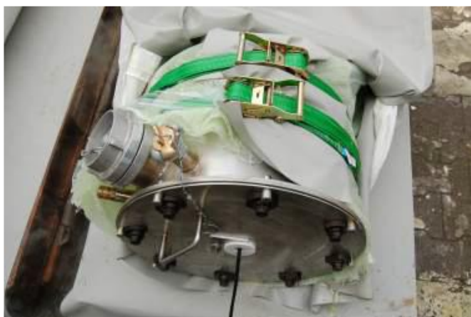
Sujeción de la manga al empacador
