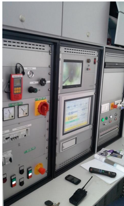
Camión con equipamiento para manga UV / Panel de control.
