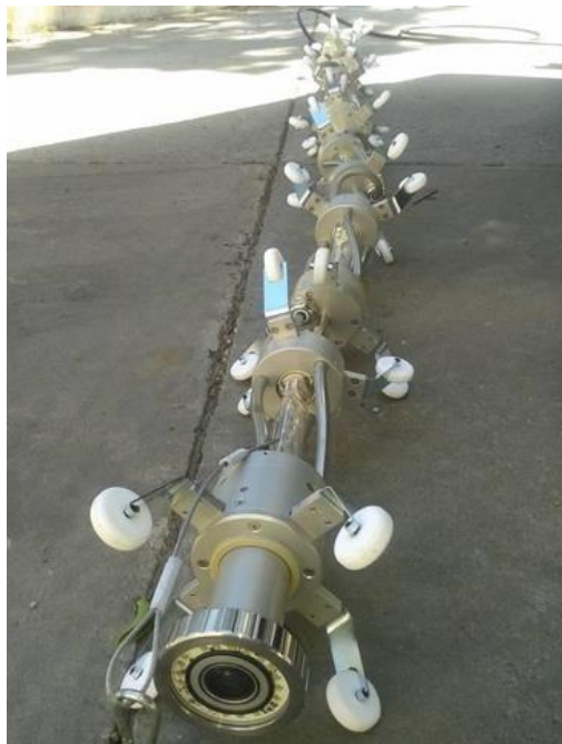
Imagen 21. Tren de luces UV (Fuente: Memoria técnica de manga de curado UV, Forever Pipe,2023)
