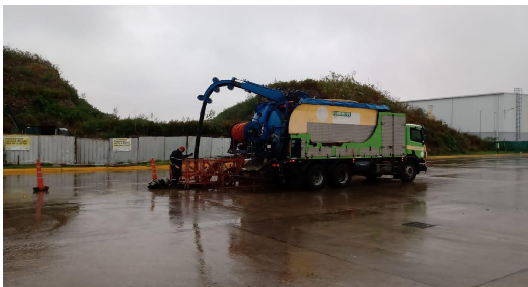
Imagen 17. Camión desobstructor en funcionamiento (Fuente: Forever Pipe,2023).
