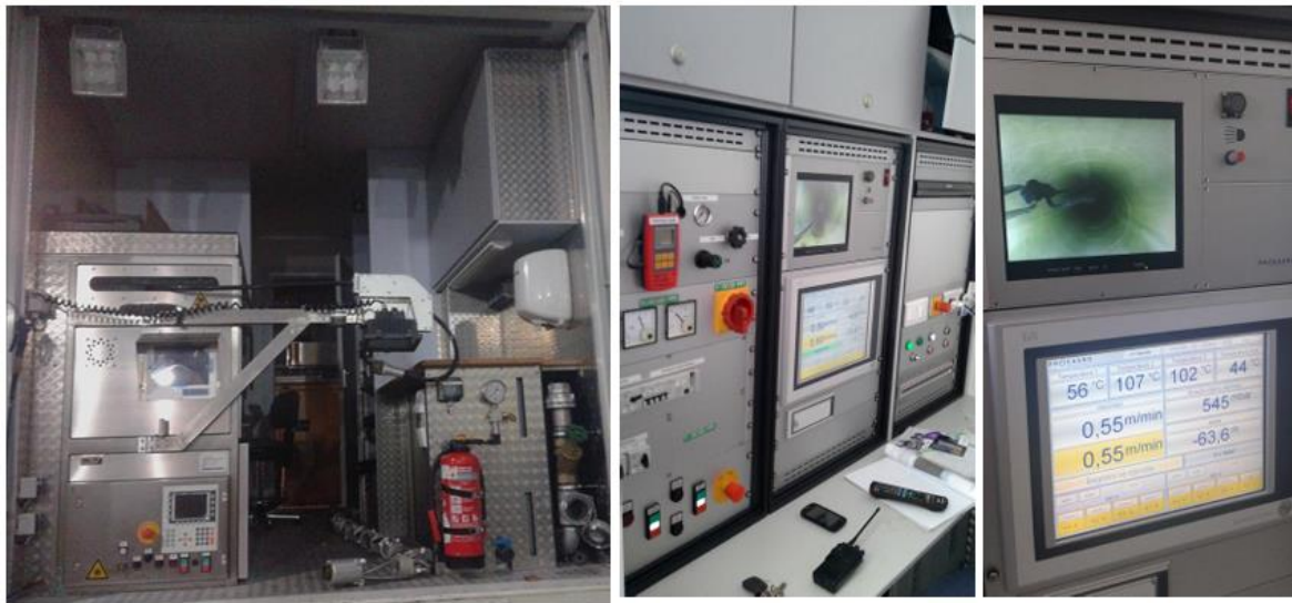
Imagen 9. Equipamiento para tele inspección (Fuente: Forever Pipe,2023).
