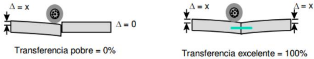
Figura 4.5.7.1. Esquema de transferencia de carga longitudinal. (Fuente: Manual de diseño de pavimentos AASHTO, 1993)
