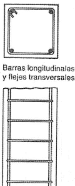
Figura 7.2.3.1. Columnas de hormigón armado. (Fuente: Moller, 2010)
