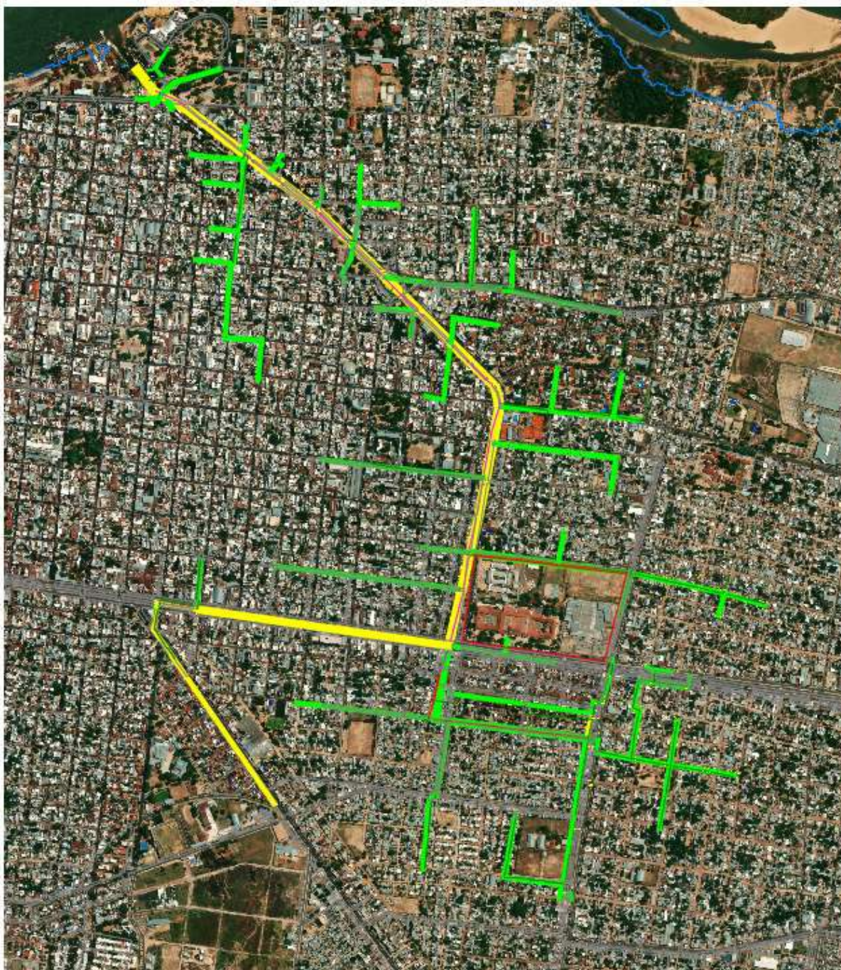
Imagen 1.3. Trazado de conductos en la cuenca de aporte (Fuente: SIG de la municipalidad de Corrientes)
