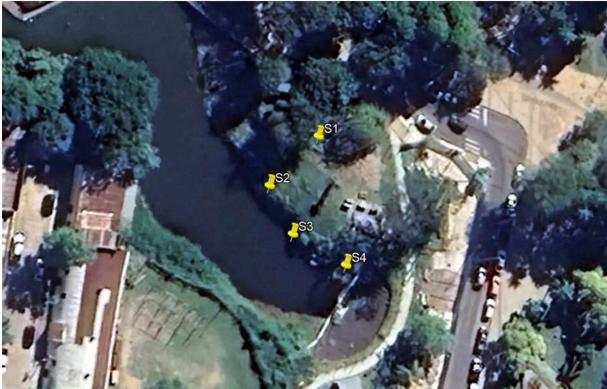
Imagen 2.8 Ubicación de los sondeos en el talud este. (Fuente: Informe del ES de Geotec, 2023)
