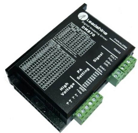
Driver Leadshine modelo DM870, Alim. 48VDC, I de salida 0,5 a 7A, micropasos 25.000/rev (en motores de 1,8°), freq. de entrada 200Khz
