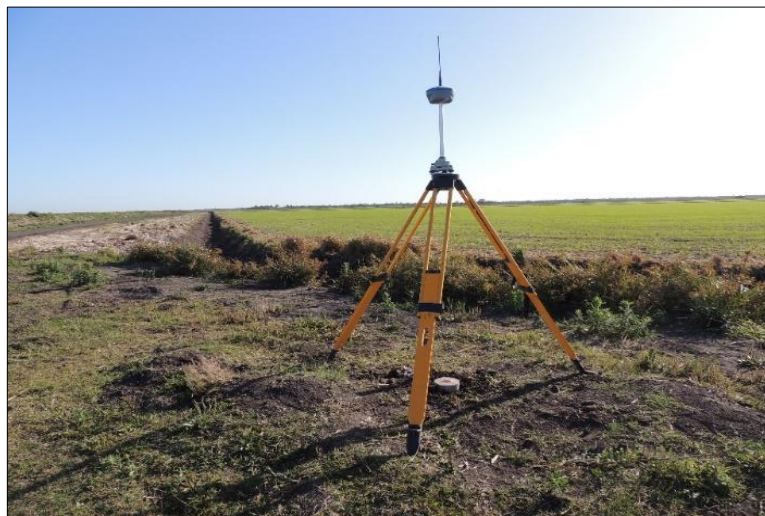
Imagen N°20: Instalación del Receptor Base sobre PF PLA - 02. Fuente: Propia.
