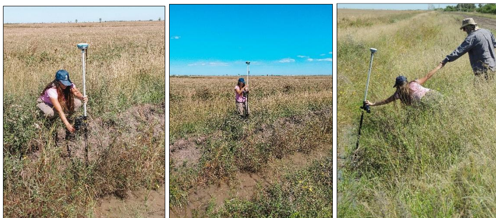
Imagen N°30: Relevamiento de desagüe. Fuente: Propia.
