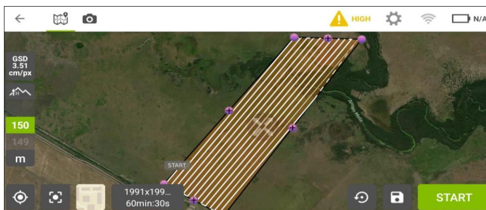
Imagen N°16: Plan de vuelo cuadrícula simple sobre el módulo 900 - Sector módulo arrocerero. Fuente: Propia.
