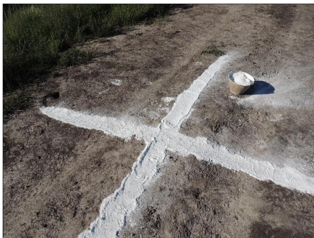
Imagen N°33: Señalización de los PAF. Fuente: Propia.
