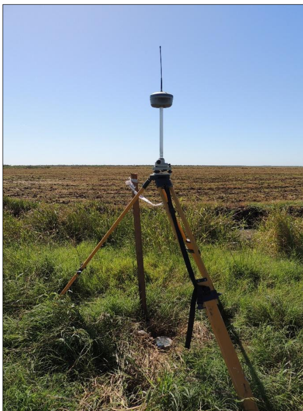
Imagen N°32: Instalación del receptor base sobre PF PLA - 02 previa medición de PAF. Fuente: Propia.
