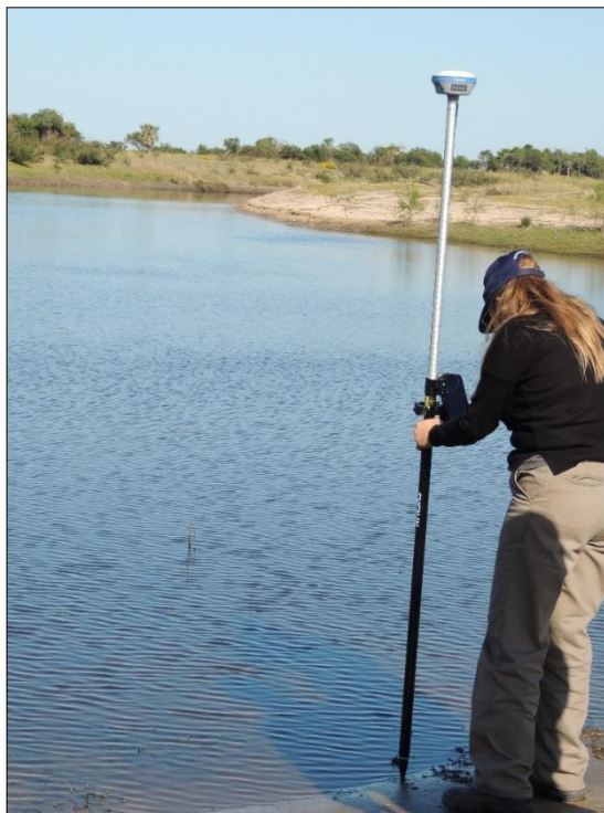
Imagen N°25: Toma de cota del pelo de agua del Río Corriente. Fuente: Propia.
