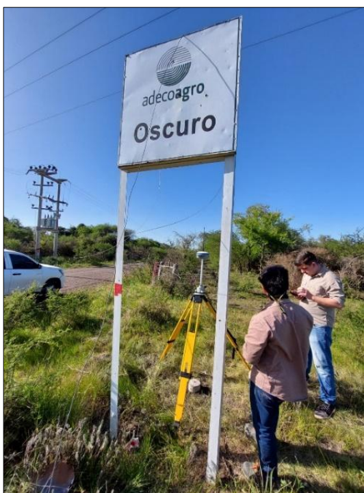
Imagen N°24: Balizamiento del PF PLA - 01. Fuente: Propia.
