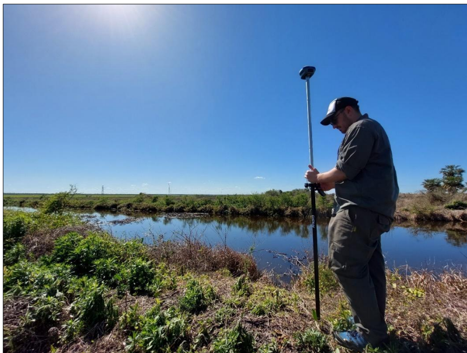
Imagen N°27: Toma de cota del Coronamiento. Fuente: Propia.
