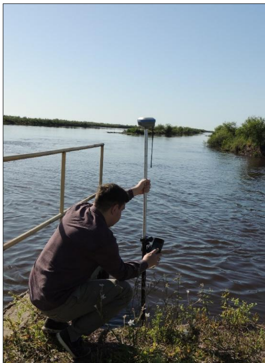
Imagen N°26: Toma de cota del pelo de agua del Canal Principal. Fuente: Propia.
