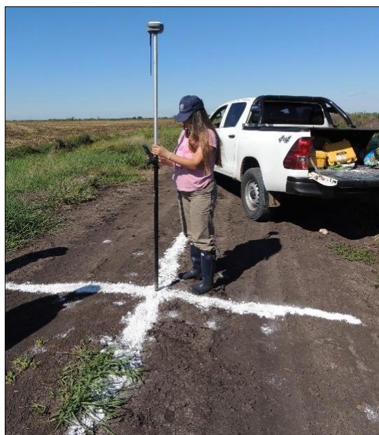
Imagen N°35: Medición de PAF con receptor GNSS. Fuente: Propia.
