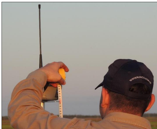
Imagen N°21: Medición la altura del Instrumento, Equipo GNSS. Fuente: Propia.
