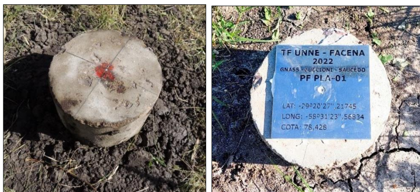
Imagen N°18: Mojón de Hormigón PF PLA - 01. Fuente: Propia.
