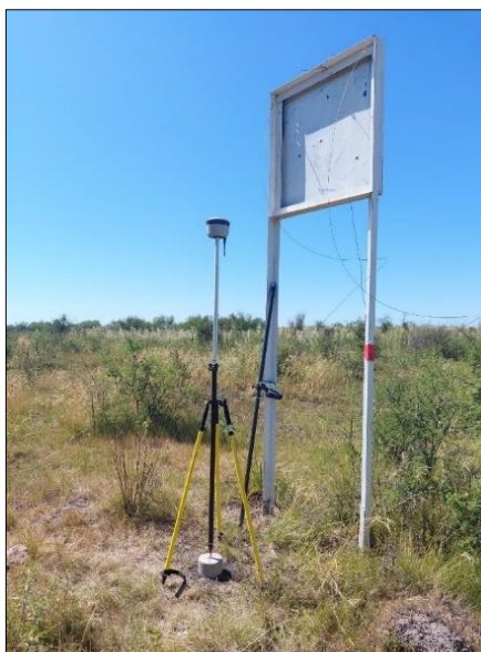
Imagen N°22: Instalación del receptor Móvil sobre el PF PLA - 01. Fuente: Propia.
