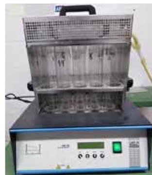
Figura N° 7. Digestión del extracto a 140^\circ\text{C} por 30 minutos.
