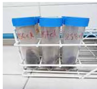
Figura N° 2. Tubos con suelos humedecidos en forma de pico de flauta y colocados en la gradilla para llevar a incubar.
