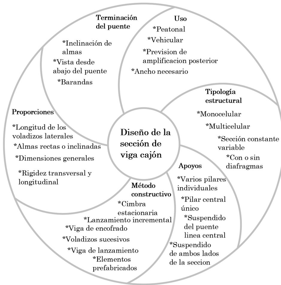
Figura II.21 Factores de diseño de la sección cajón (Fuente: Adaptación de [1]).
