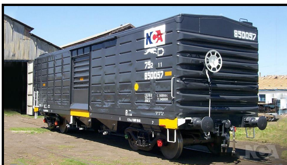
Imagen 16. Vagón cubierto de carga general CT 19. (Fuente: Ferrocarril Nuevo Argentino S.A.).
