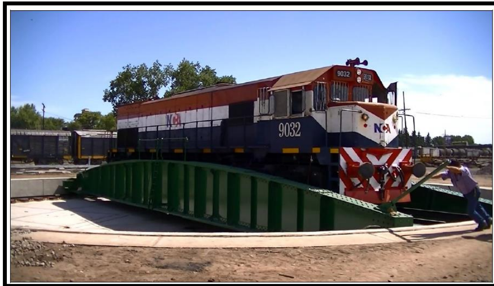
Imagen 39. Mesa Giratoria en patio parada (Fuente: Manual Integral de Vías).
