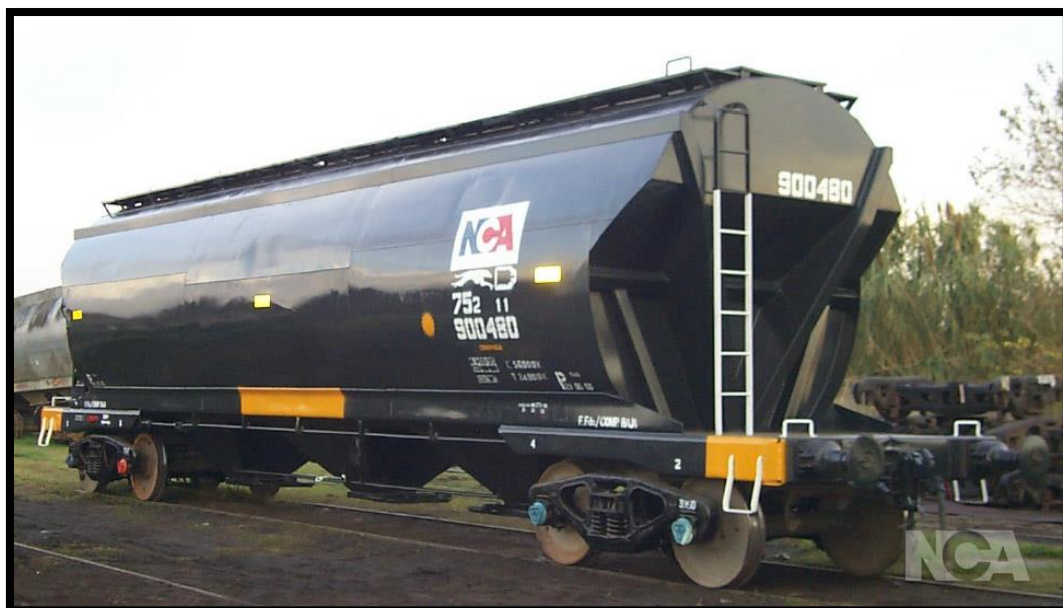
Imagen 15. Tolva granelera CT 75 (Fuente: Ferrocarril Nuevo Argentino S.A.).
