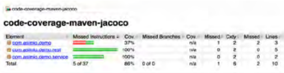
Figura 47. Ejemplo de reporte de cobertura utilizando la herramienta JaCoCo.
