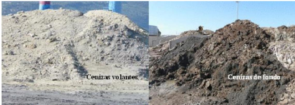
**Imagen n°8.** Tipos de cenizas producidas por la combustión de la biomasa residual (fuente: Propuesta para la reutilización agrícola de las cenizas generadas en la obtención de energías renovables a partir de la biomasa residual-Universidad de Granada).
