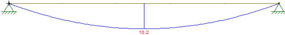
**Imagen n°30.16.** Diagrama de momento flector en el sentido X (fuente: elaboración propia).
