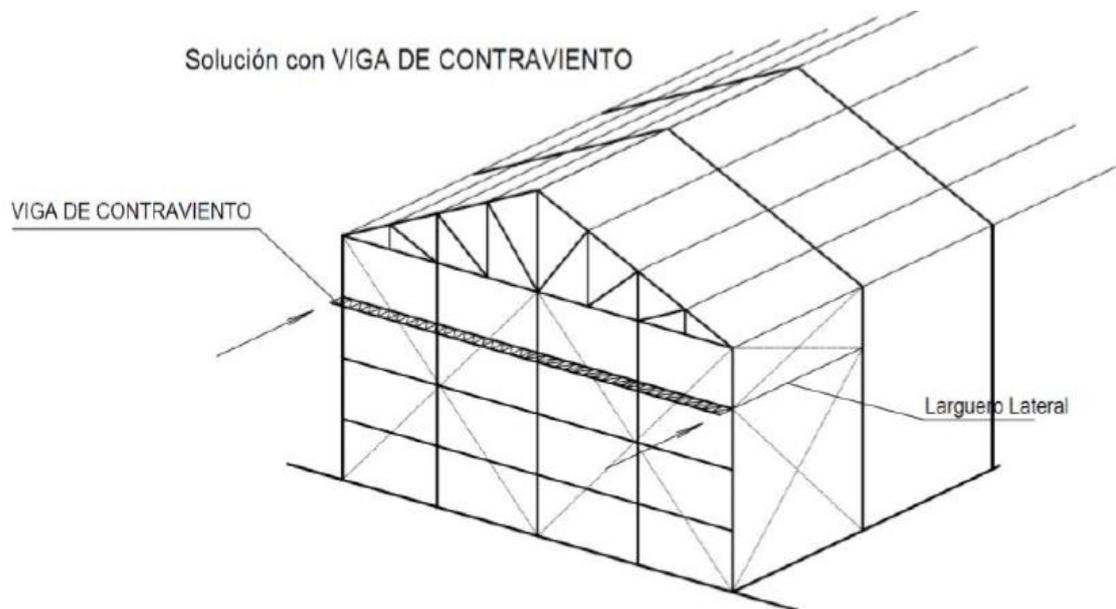
**Imagen n°17.** Esquema de la viga de contraviento (fuente: cátedra Construcciones Metálicas).
