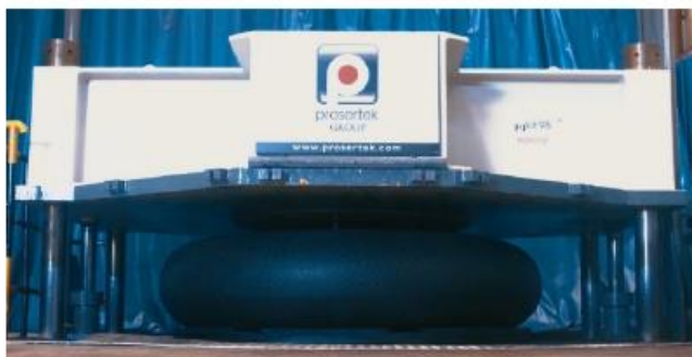
Figura 40 – vista de la deformación de la defensa tipo TCN y armadura con escudo horizontal.
