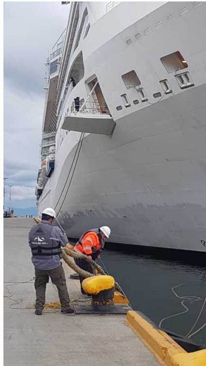
Figura 28 – vista maniobra de amarre de crucero en lado Oeste sector 3 del Puerto de Ushuaia
