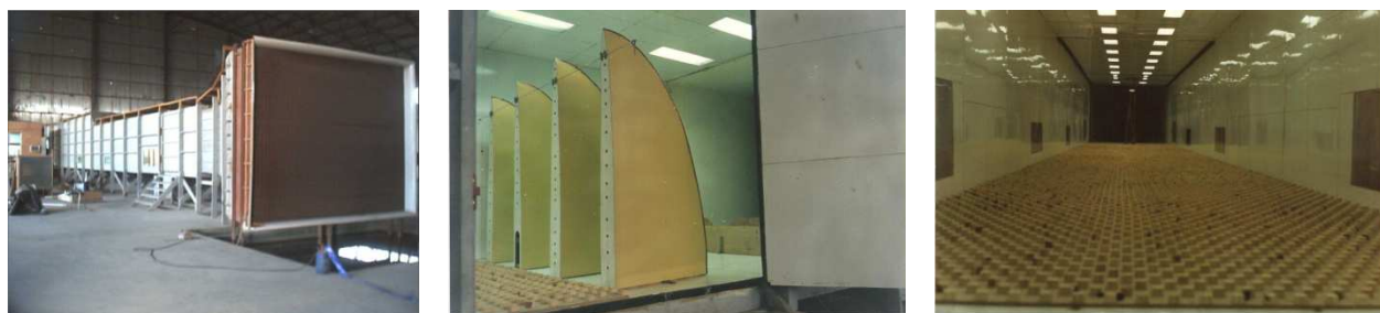
Figura 2. Túnel de viento “Jacek P. Gorecki”, generadores de Counihan y elementos de rugosidad para la simulación del viento natural.
