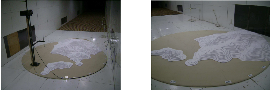
Figura 11. Modelo topográfico en la cámara de ensayos del túnel de viento.
