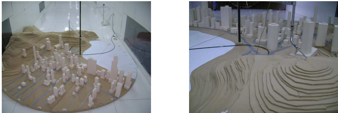
Figura 5. Montaje del modelo para la dirección de viento correspondiente a 345°.
