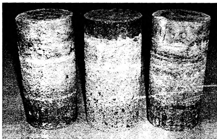
Foto N° 1: Hormigones expuestos a la solución en Pileta 1. (Las probetas a la derecha y a la izquierda contienen adiciones)
