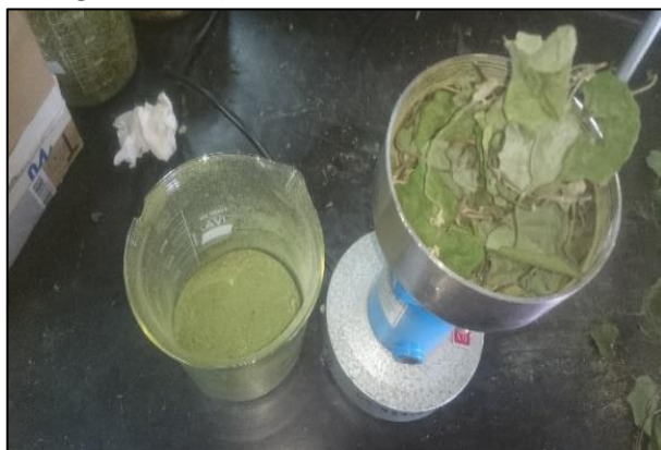
Figura 13. Molinillo a hélice Numak, modelo F100 utilizado para moler el material vegetal.
