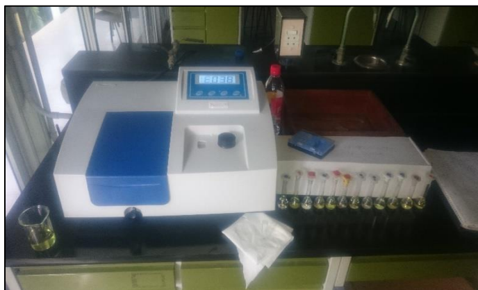
Figura 18. Espectrofotómetro Exylon UV-VIS y muestras empleadas determinación de flavonoides totales.
