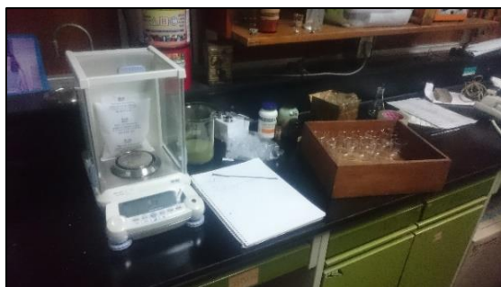
Figura 14. Balanza analítica Shimadzu, modelo AUY220, con precisión de 0,1 mg, utilizado para la determinación de masa del material vegetal.
