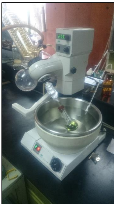
Figura 16. Rotavapor Buchi, modelo R-124, utilizado para el secado del material vegetal a presión reducida y temperatura controlada inferior a 50° C.
