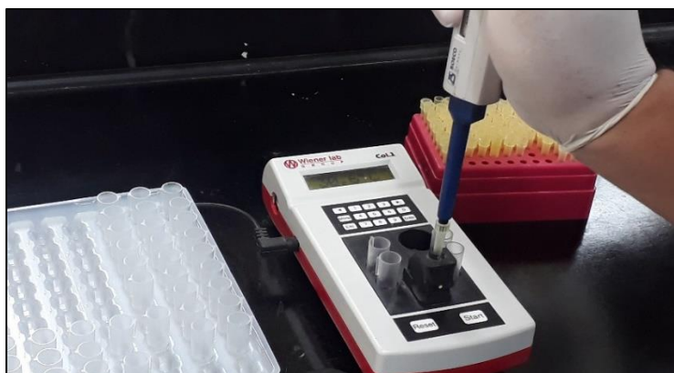
Figura 20. Coagulómetro Col1 de Wiener lab. utilizado para la determinación del tiempo de coagulación del plasma.
