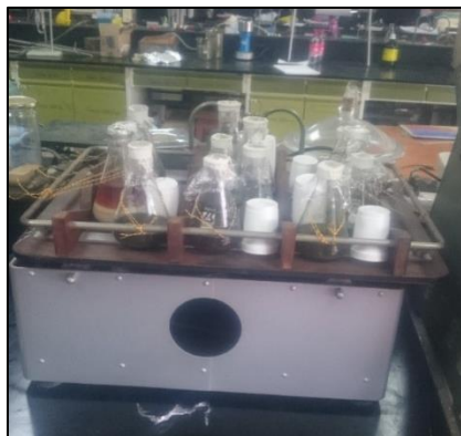
Figura 15. Instrumento utilizado para la agitación continua del material vegetal.
