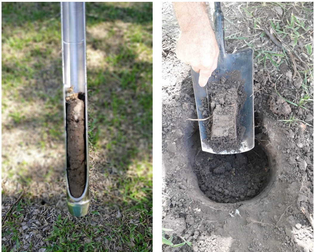
Figura 3. Muestras extraídas con barreno y pala de punta (con las porciones laterales eliminadas).
