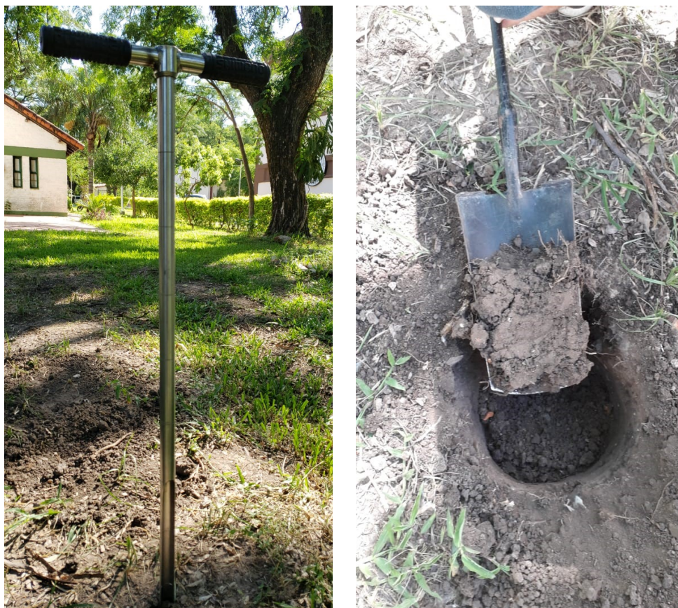
Figura 2. Posición correcta del barreno y pala de punta para la toma de muestra.
