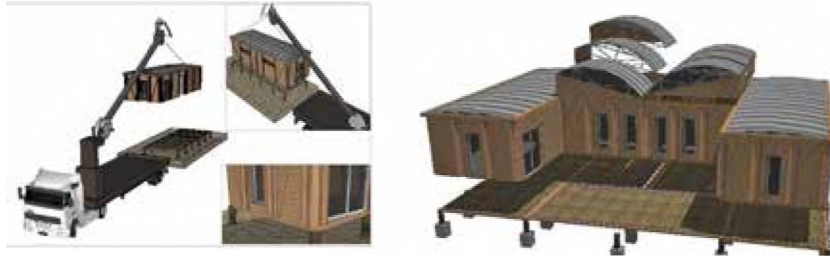
Figura 3. Diseño de alumna del ciclo 2009: sistema constructivo de células tridimensionales a partir de vagones de tren en desuso.
