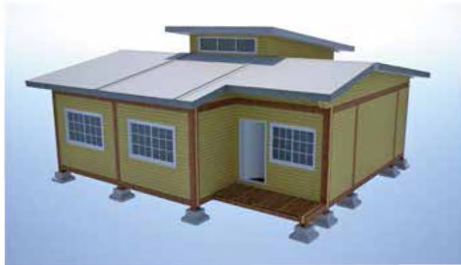
Figura 1. Imagen habitual de las propuestas de diseño arquitectónico y tecnológico de viviendas que venían desarrollándose hasta el ciclo lectivo 2008, resueltas mediante construcción prefabricada de pequeñas piezas en madera.
