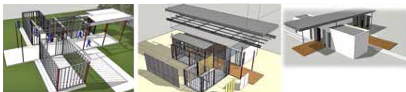
Figura 6. Diseño de alumnos del ciclo 2011: construcción en seco mediante entramado metálico, aplicada a un módulo de información turística.
