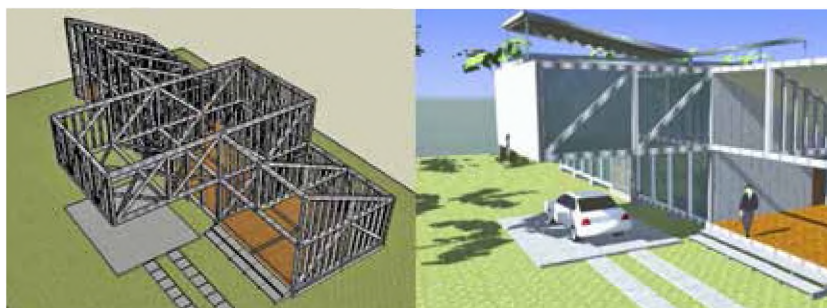
Figura 2. Diseño de alumno del ciclo 2009: sistema constructivo no convencional de construcción en seco, tipo steel frame, resuelto con una gran libertad formal y aplicado a una vivienda.
