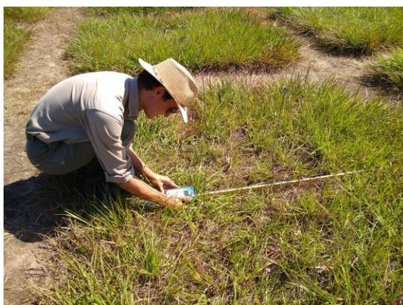
**Figura 2.** Medición de la iPAR em uma parcela sin fertilización nitrogenada.
