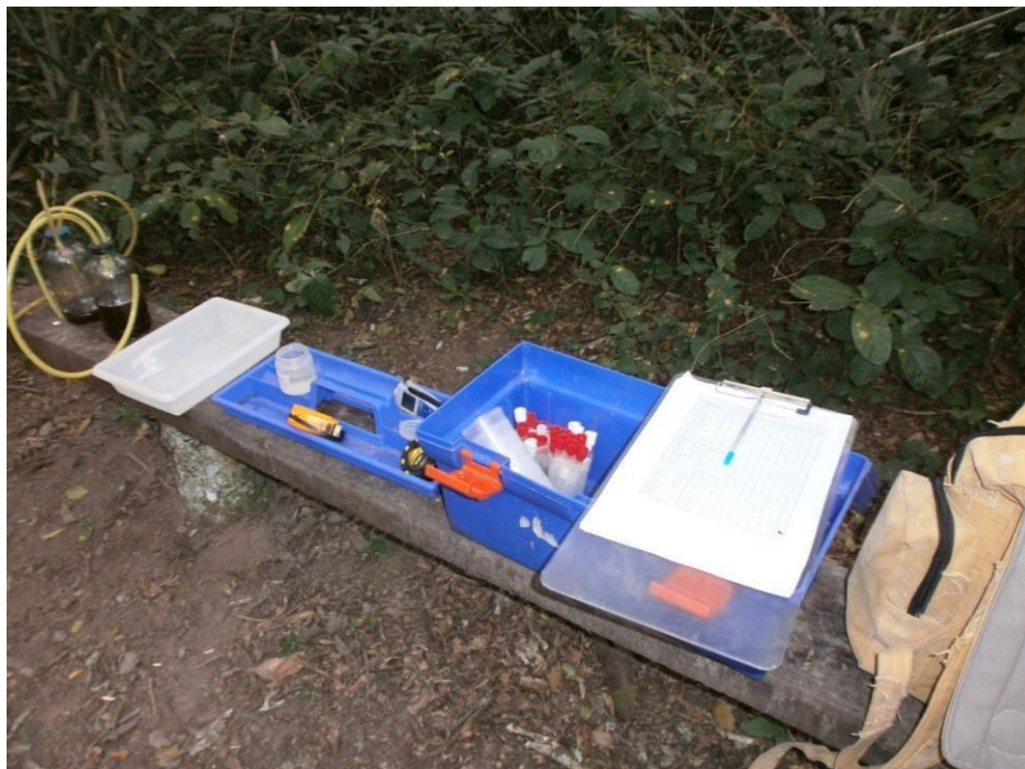
Figura 9 - Equipo para registro y recolección de culícidos en el campo: planilla de registro, tubos y frascos para transportar material, frascos aspiradores, bandejas plásticas.
