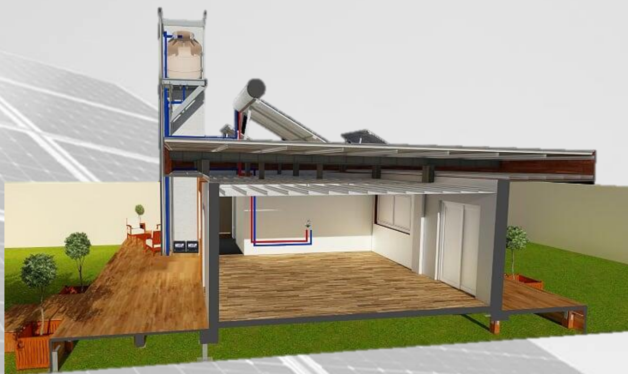
GRÁFICO 30. INSTALACION Sistema fotovoltaico y colector solar.
