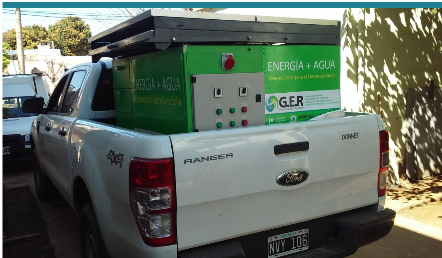
Las dimensiones del equipo construido le permite ser transportado en un vehículo utilitario
