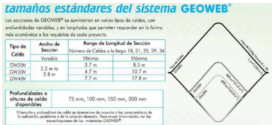
Figura 98. Características técnicas de las geoceldas comerciales (fuente: catálogo Coripa S.A)
