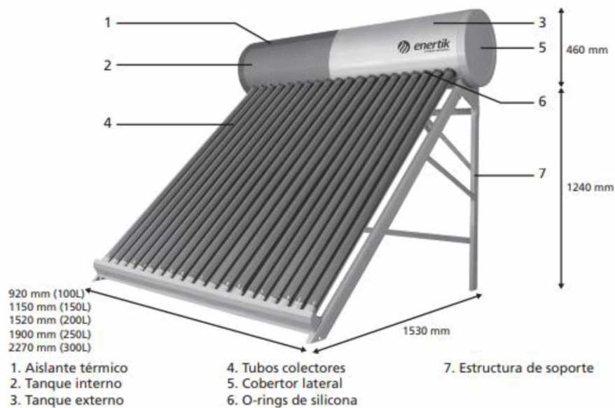
Figura 102. Termotanque Solar utilizado (Fuente: Manual Enertik)
