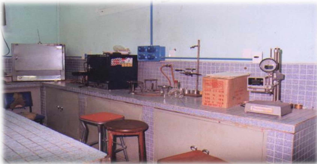
Figura 56. Laboratorio de Asfaltos, mesada con elementos de utilizados en los ensayos como ser estufa, penetrómetro, mechero, entre otros. Fuente: http://ing.unne.edu.ar/vias/vias.htm
