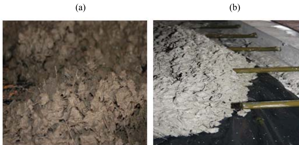
Fig.2.1: CHODOUNSKY [7]: (a) Adición de fibras al cemento; (b) Fibras aumentando la resistencia al corte del hormigón
