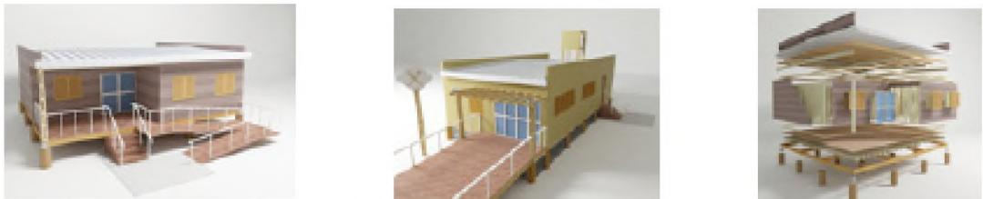
Fig. 5: Diseño de alumnos del ciclo 2010: construcción en seco sobre palafitos (mediante sistema tipo balloon frame y revestimientos exteriores de placas de cemento e interiores de placas de yeso), aplicada a un comedor de emergencia.
