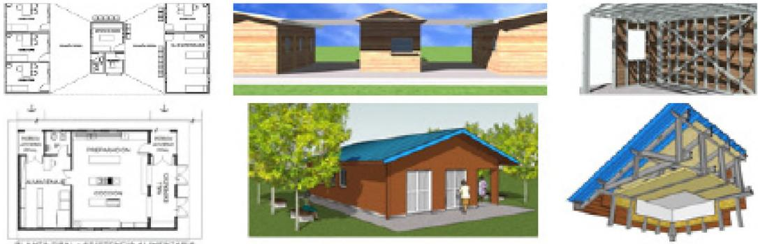
Fig. 3: Diseño de alumnos del ciclo 2010: construcción en seco (mediante sistema tipo steel framing y revestimientos exteriores e interiores de madera), aplicada a un módulo para situaciones de emergencia/catástrofe destinado a centro de salud (arriba) y comedor (abajo).
