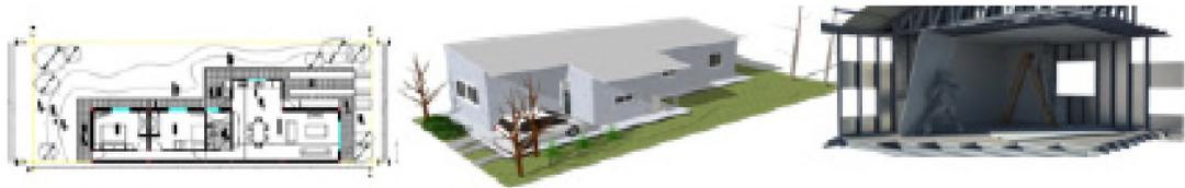
Fig. 4: Diseño de alumnos del ciclo 2010: construcción en seco (mediante sistema tipo steel framing y revestimientos exteriores de chapa lisa e interiores de placas de yeso), aplicada a un módulo para vivienda de emergencia.
