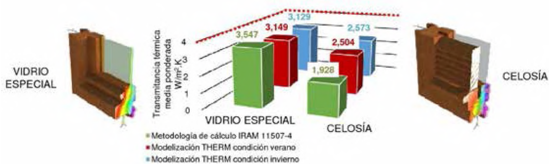
Figura 8. Comparación de valores de transmitancia térmica media ponderada entre propuestas de rehabilitación térmica para el grupo C: carpinterías de madera. Fuente: Suárez, Betiana Rocío; Jacobo, Guillermo José (2015)
