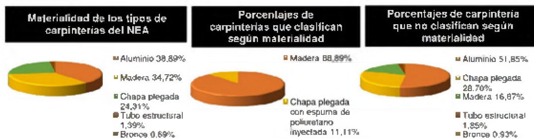
Fig. 4. Porcentajes de clasificación de carpinterías para la Norma IRAM 11507-4. Fuente: Suárez, Betiana Rocío; Jacobo, Guillermo José (2014)
