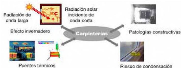
Fig. 3. Problemas higrotérmicos frecuentes en carpinterías Fuente: elaboración propia sobre la base de datos de la ponencia de Ramos, Eduardo M. (2011) Rehabilitación térmica de cerramientos de huecos vidrios y marcos térmicamente eficientes
